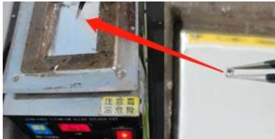
图14 微型射频开关连接器可焊性测试示意图
