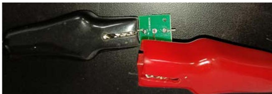
图6 绝缘耐压测试仪的夹子与待测样品的连接示意
