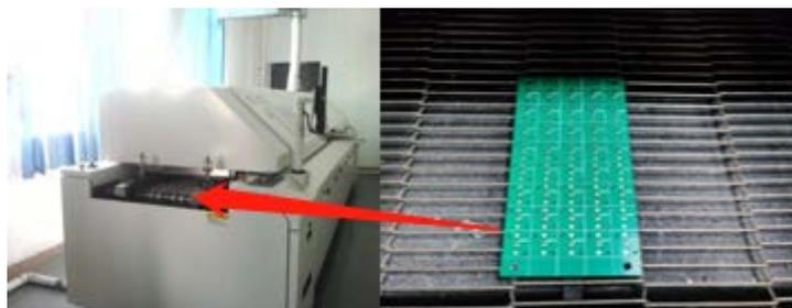
图15 微型射频开关连接器过回流焊示意图
