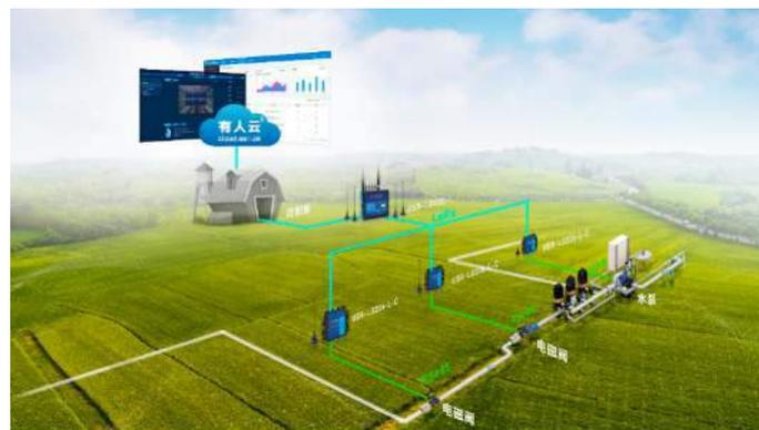
3、工作人员在监控室里，可以通过监控大屏实时查看农田用水情况，根据实际需要远程下发指令，控制电磁阀启停工作。
