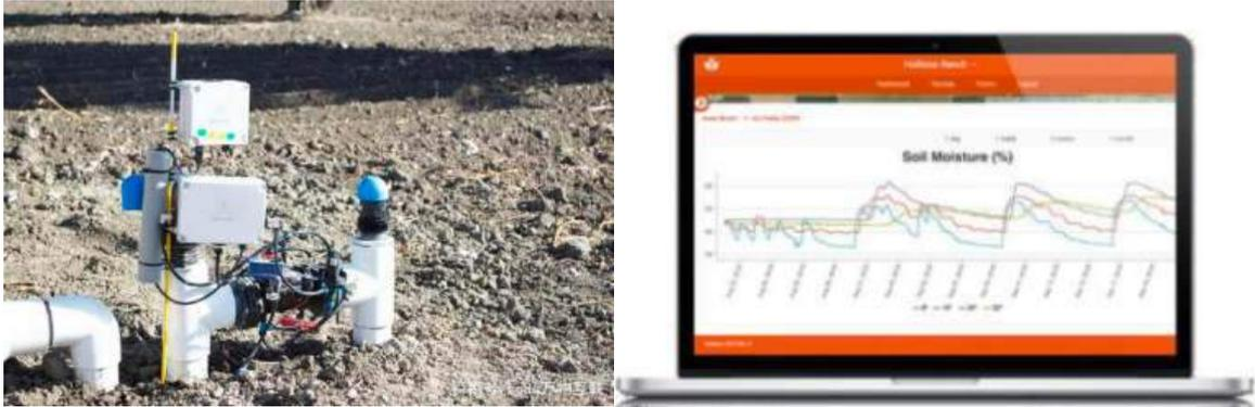
如上图所示节点作为自动化灌溉系统中的关键一环，carbon 节点采用太阳能供电真正做到拿来即用。通过 carbon 节点连接传感器、探针、阀门。WaterBit 还提供：电容性的土壤湿度检测探针，用以检测土壤湿度；压力和流量传感器二合一，做到水流监控和泄露检测；无线断流阀控制器，精确控制水流。这些数据传输和控制都是通过 LoRa 来实现的。
