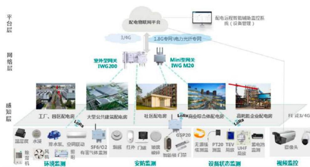
CLAA 配电房物联网整体架构图
