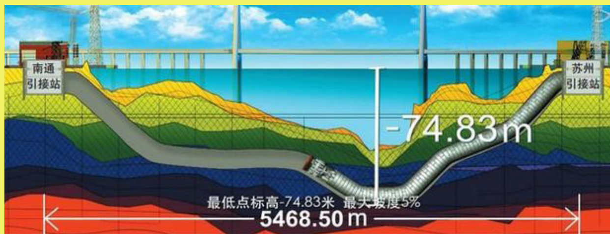
苏通管廊隧道剖面示意图
